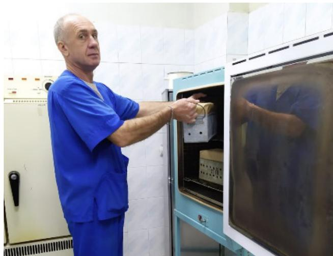
*Медицинский дезинфектор В.В. Шаталов загружает пробирки в суховоздушный стерилизатор.*
